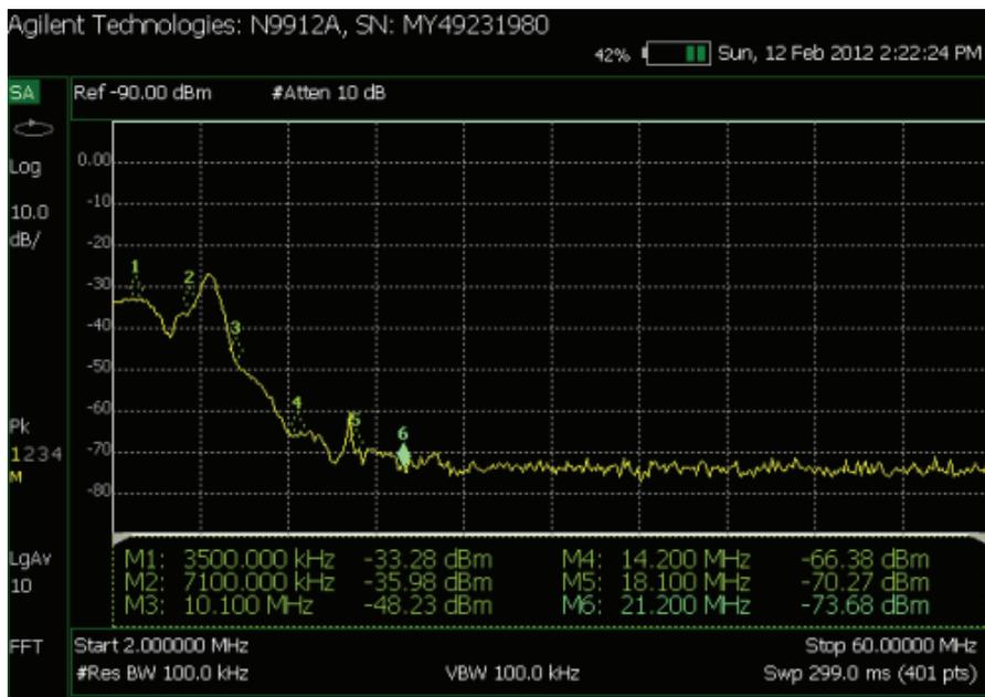
Am testat apoi un alimentator de laptop TOSHIBA, PA3714E-1AC3, de 19 Volti si 3.95 amperi. Productie an 2009/2010. Curent de sarcina de 2 amperi.
