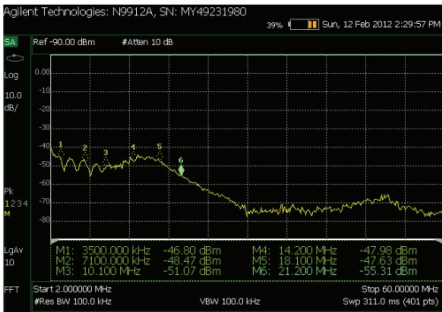
Am testat si o sursa de laptop DELL (un model scump), tip DA90PS2-00, an de fabricatie 2009, la un curent de sarcina de 2 amperi.
